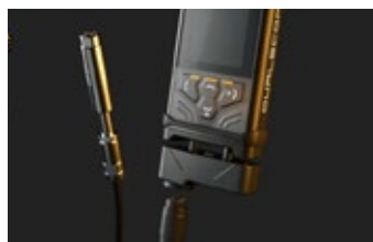
従来のアナログプローブ接続するためのFプローブアダプター
