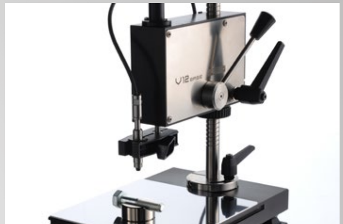
測定サンプルのホルダーとプローブを測定スタンド(手動式のV12 Base)で固定し繰り返し測定
