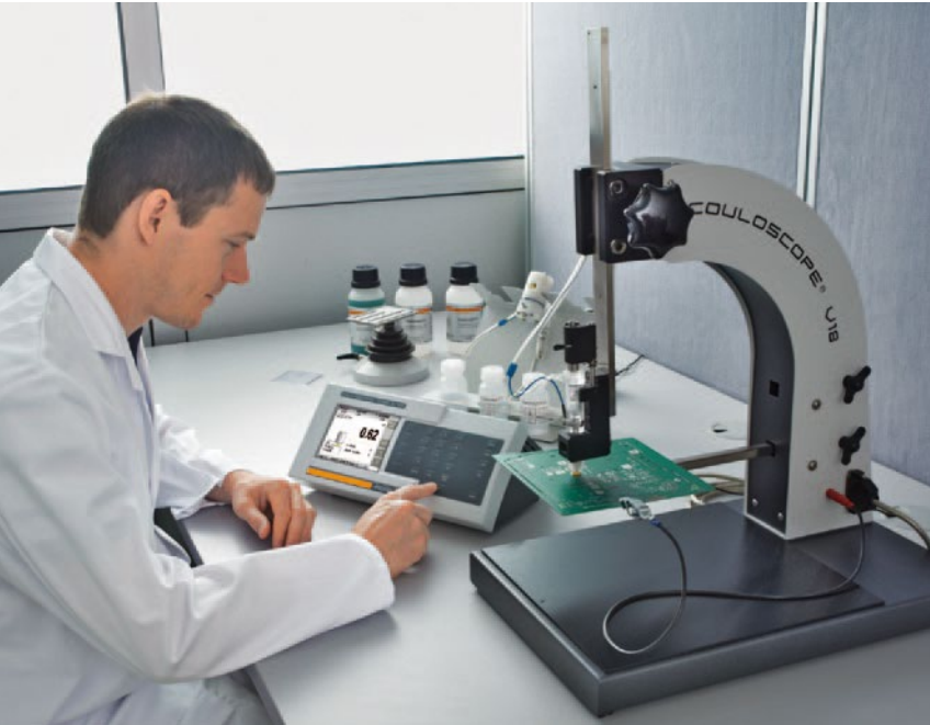
プリント回路基板上に残留する純錫の厚み測定の実験イメージ
