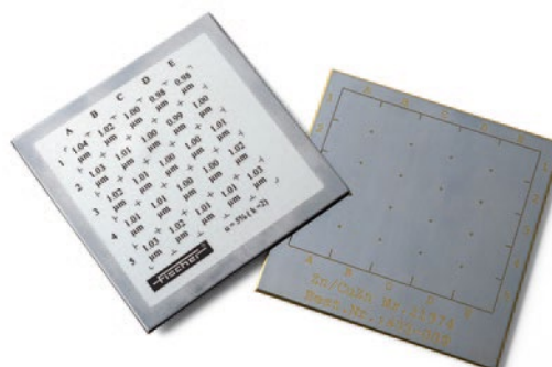
5 x 5の測定テスト領域を含む測定キャリブレーション用標準板
