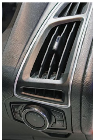
CMS2 STEPの典型的な用途：自動車製造における多重ニッケル皮膜を基にしたクロムめっきされたトリム
