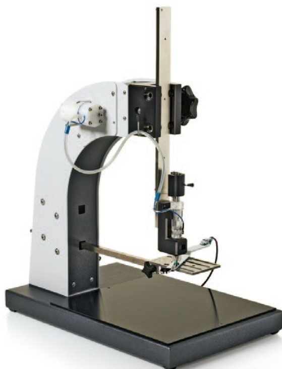
幅広く応用できる標準のサポートスタンドV18 ワイヤーの膜厚を測定するためのサポートスタンドV27
