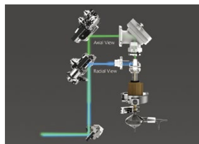
デュアルビューテクノロジーは、低い検出下限が求められるサンプルにはアキシアル測光で、高濃度までの検量線範囲を広げるためにはラジアル測光で測定できます。
