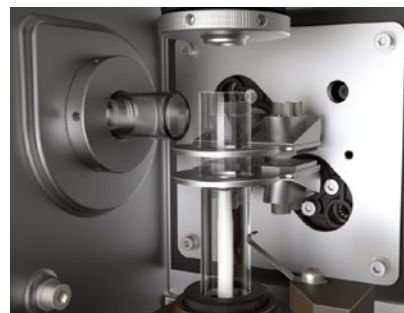
Avio 550/560 Max は、トータル 9 L/min のアルゴンプラズマ流量で運用できます。10 時間 / 日 (200 日 / 年の運用) とすると、～ 150 万リットルのアルゴンガスを節約できます。
