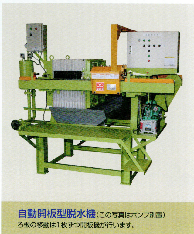
8 油圧切り換えレバー 押し枠の開・閉は油圧ポンプレバーの切り換えで簡単に行えます。
