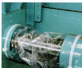
9 油圧シリンダー 故障の少ない複動式油圧シリンダーで、押し枠の開・閉を行います。
