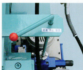
8 油圧切り換えレバー 押し枠の開・閉は油圧ポンプレバーの切り換えで簡単に行えます。
