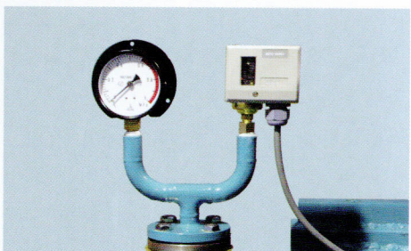
4 スラリーの打ち込み圧力を測定して、適正なケーキ厚みになるようタイマーで制御します。
