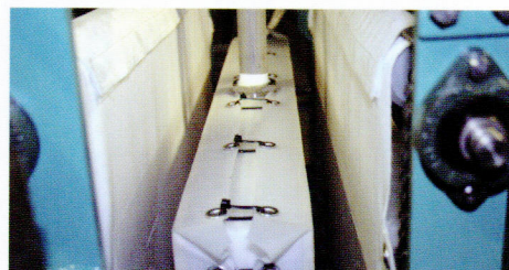
2 隔膜用ろ布、移動用ろ布とも構造はきわめてシンプルで、交換も簡単に行える構造になっています。
